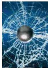
Test à Bille Norme EN 356 Ball-drop test EN 356 standard
